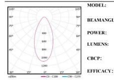
EIR2NF-02ET-530SS BEAMANGLE: 3W (Max) 80 lm 23 lm/W
